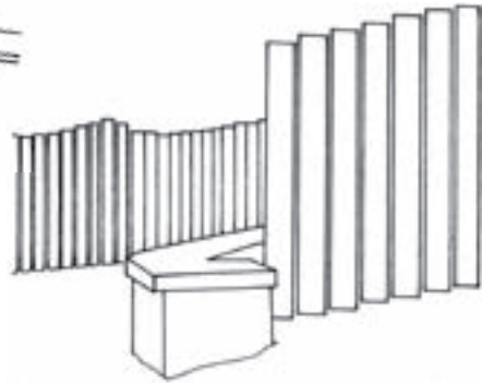
ZÁMĚRNĚ NESTEJNÁ ROVINA UKONČENÍ PRKEN V PLOTU
