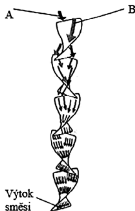
Obr. 3.12: Průběh směšování dvoukomponentních lepidel na principu směšovače
