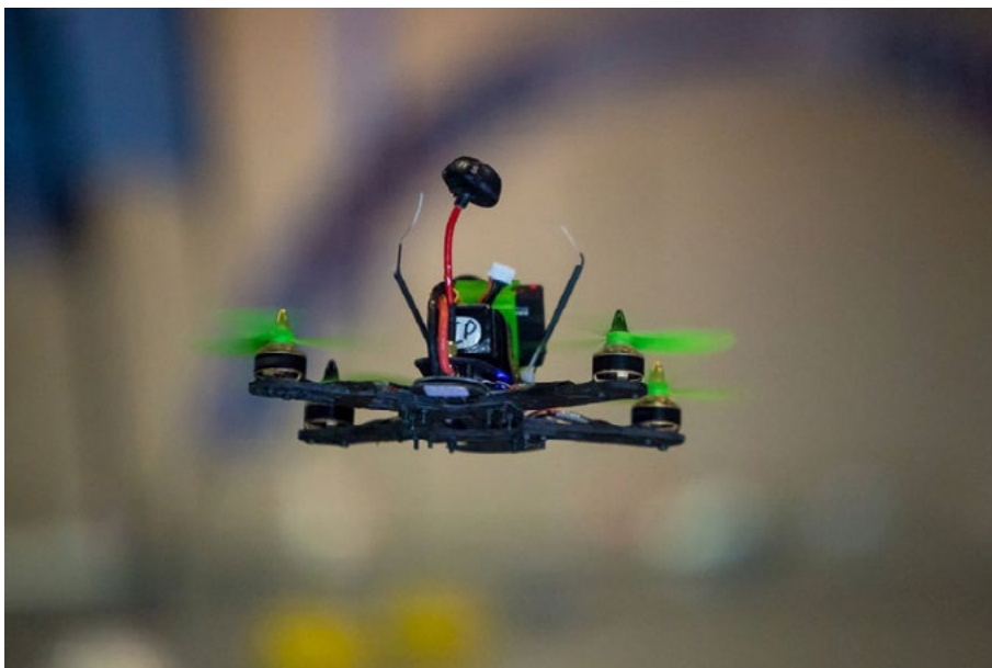
Obrázek 12: Malý dron určený pro FPV závody má malé vrtule
