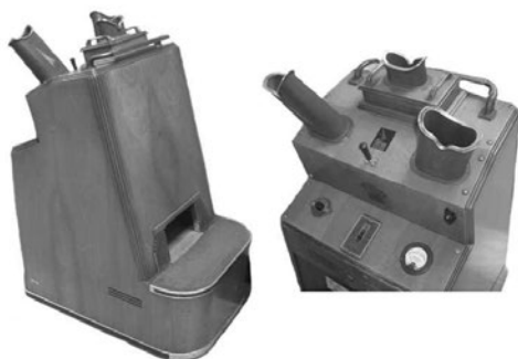
Přístroj k prozáření nohou, zvaný pedoskop, jaký bylo možno v Německu vidět v obchodech s obuví ještě na začátku sedmdesátých let minulého století.
