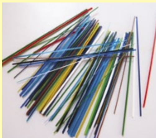
Nitkový smalt, taháný z roztaveného smaltu
